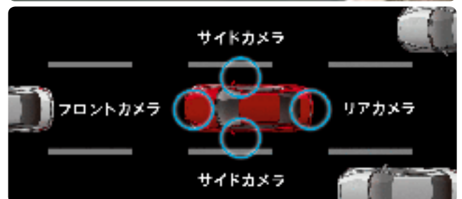
フロント・サイド(左右)・リアの4カメラでセンターディスプレイに周囲の映像を表示し、ドライバーの死角となる領域が認知できる。
